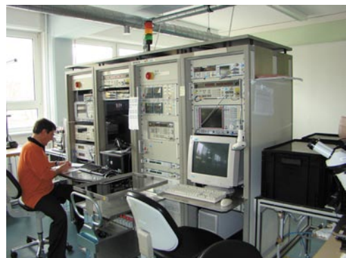
Komplexe HF-Prüfung an einer eigenentwickelten Anlage außerhalb des Reinraumes
