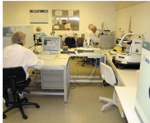
Qualitätsprüfung von rechts: Plasmareinigung, optische Inspektion, Schichtdickenmessung, Röntgenfluoreszenzanalyse
