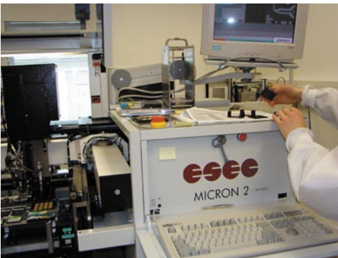
Die Steuerung der automatischen Bestückungslinie mit Vision-System
