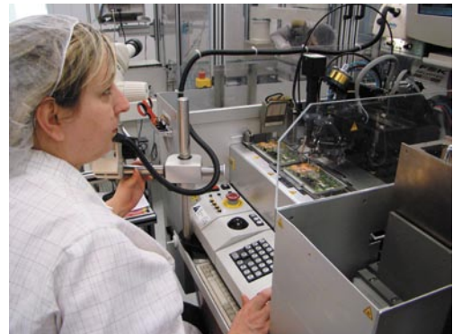
Drahtbonden mit Zuführung im Rack
