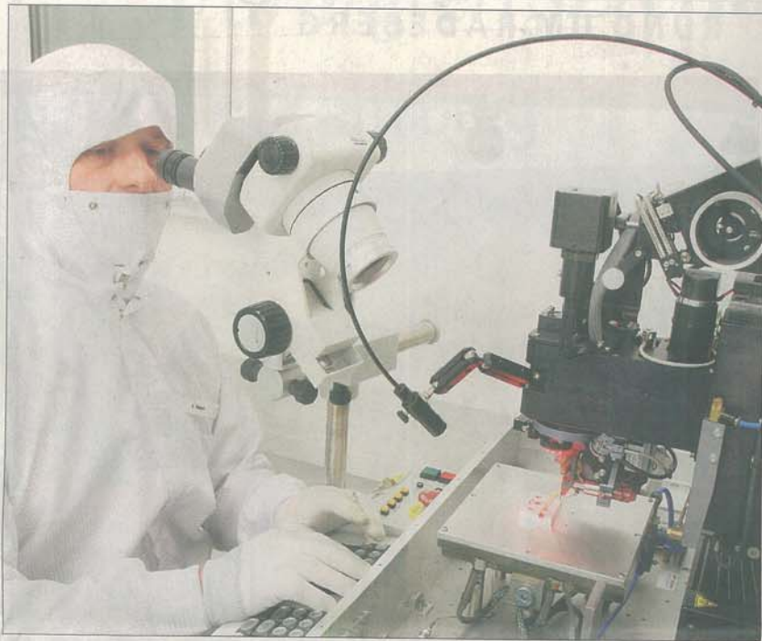
Arbeiten unter Reinraumbedingungen: Holm Weber am Vollautomatischen Drahtbonder. Die Radeberger Firma RHe Microsystems GmbH fertigt hochkomplizierte Mikroelektroniksysteme und Elektronik-Module. Foto: Michael Trapp
